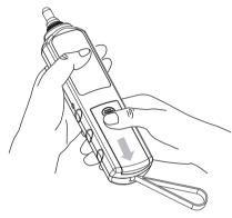
▶正确的将两个AA电池放入电池仓内,注意电池的极性,然后合上电池门,如下图:
